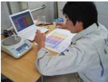
燃料計測 出走前と完走後には必ず精密な燃料計測を行います。その消費燃料から燃費を計算します。
