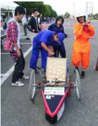
燃料計測 出走前と完走後には必ず精密な燃料計測を行います。その消費燃料から燃費を計算します。
